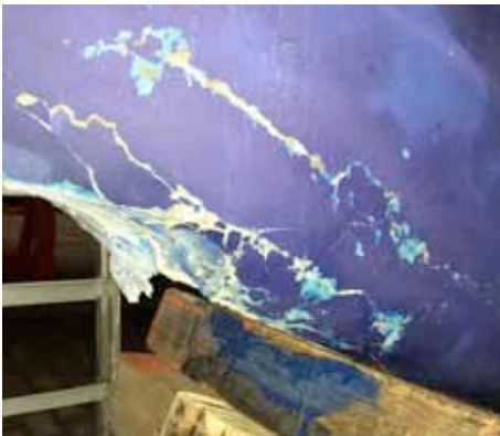
Grundberührung mit Folgen
